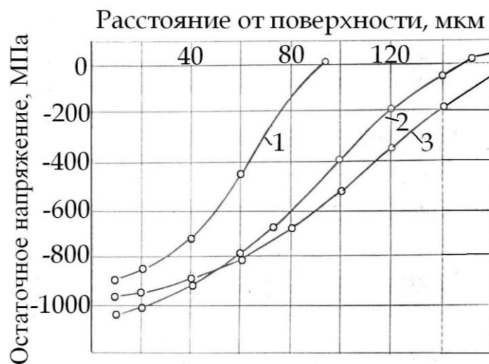
Рис. 3. Изменение остаточных напряжений в поверхностном слое сплава ЖС6ФН после обработки микрошариками \varnothing 160-200 мкм V=40 м/с: 1 – \tau=15 с; 2 – \tau=45 с; 3 – \tau=120 с
