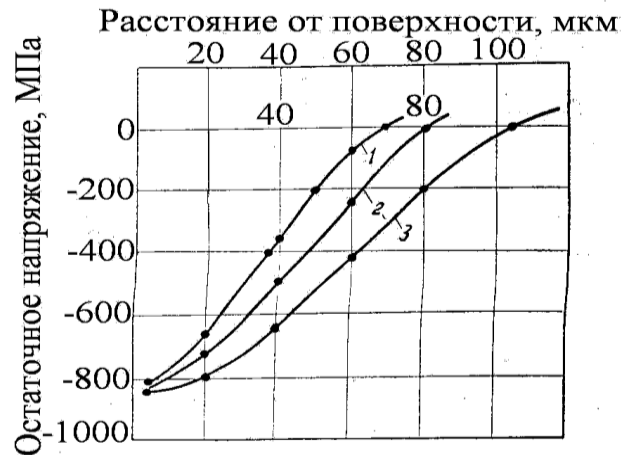
Рис. 2. Изменение остаточных напряжений в поверхностном слое сплава ЖС6ФН после обработки микрошариками V=40 м/с: 1 – \varnothing 63-100 мкм; 2 – \varnothing 100-160 мкм; 3 – \varnothing 160-200 мкм
