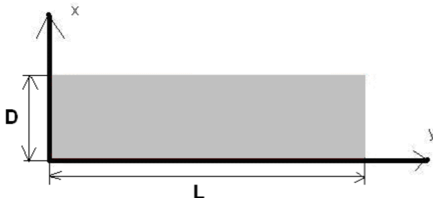
Рис. 1. Продольное сечение трубопровода
