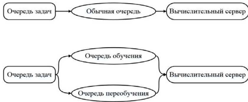
Рис. 2. Обычный менеджер очереди и менеджер с параллельными очередями Все это объединяется основной управляющей программой.
